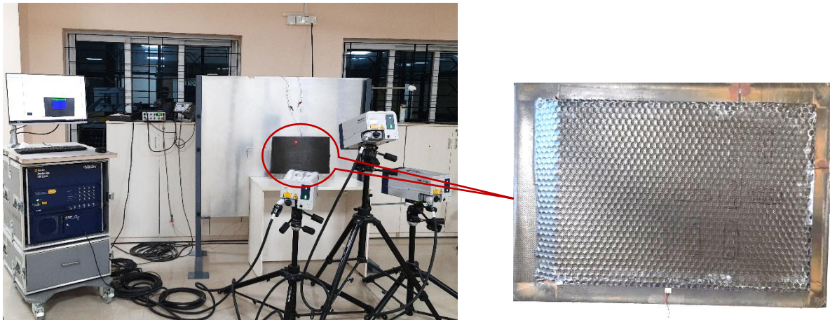
चित्र 1: (a) प्रयोगात्मक व्यवस्था और (b) रैखिक सम्मिश्र मधुछत्ता पैनल चित्र
